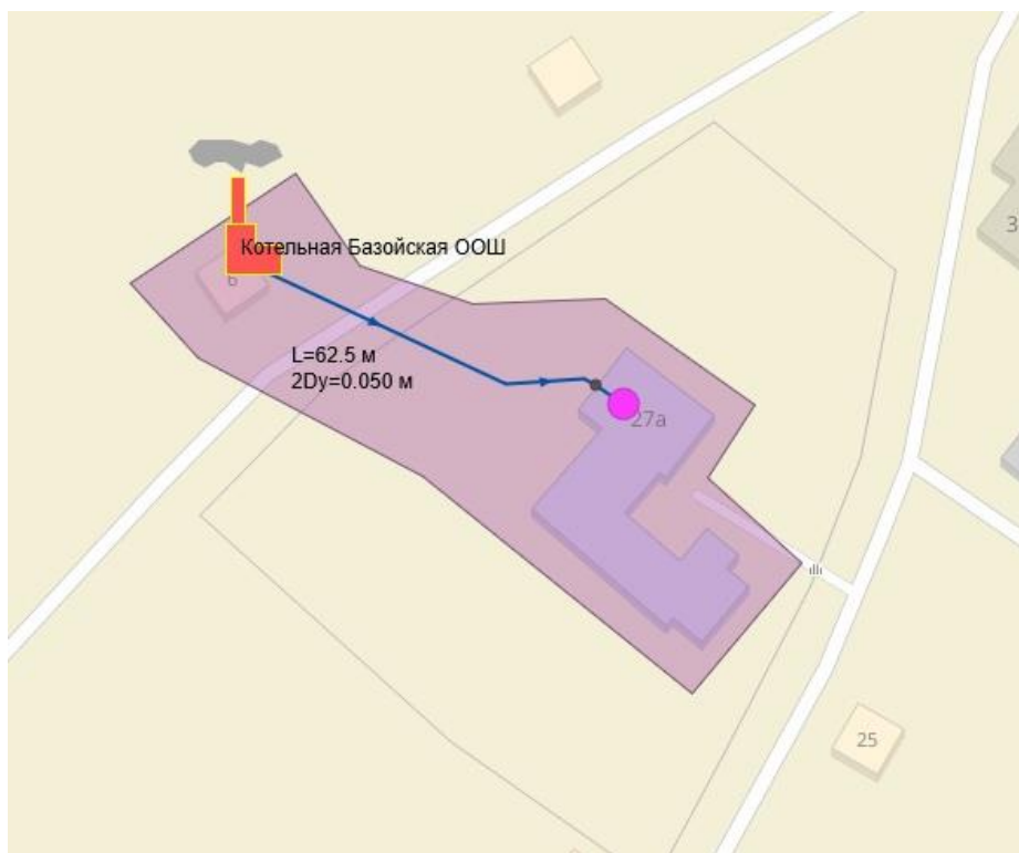
Рисунок 8 – Зона действия котельной Базойской ООШ
